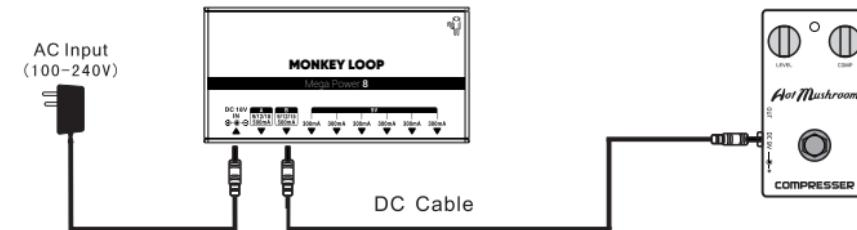
1. Si la polaridad de entrada del dispositivo eléctrico es , conecte el cable de alimentación de CC directamente al dispositivo, como se muestra.
